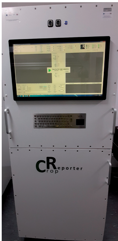
Slika 20: CropReporter™ uređaj za fenotipizaciju biljaka
